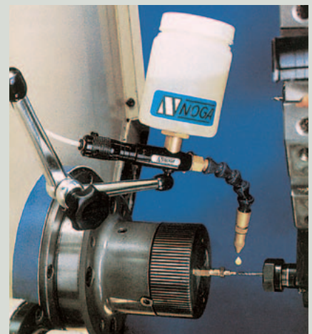
CNC旋盤内でのコブラ使用例 旋盤のNC回路を利用して切削液とエアの噴射 を交替におこなう設定をすることができます。
