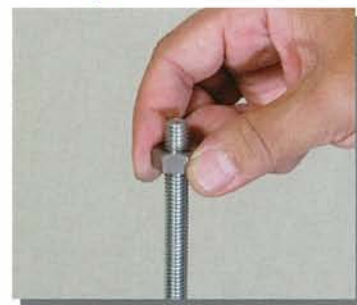
▲切断完了 (切断のままナットが掛かる)
