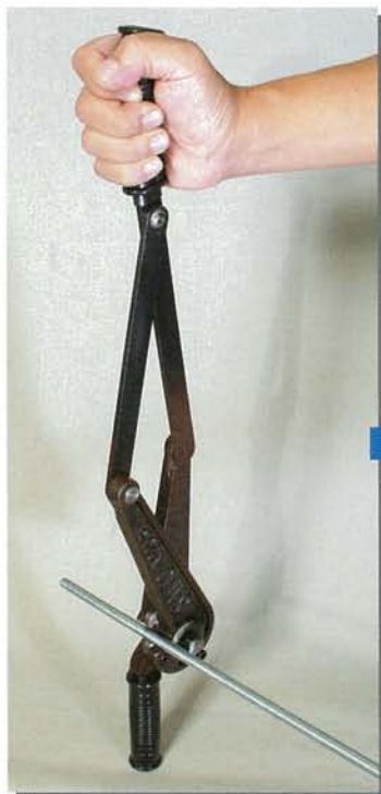
▲ハンドルを開いて 全ネジボルトを挿入
